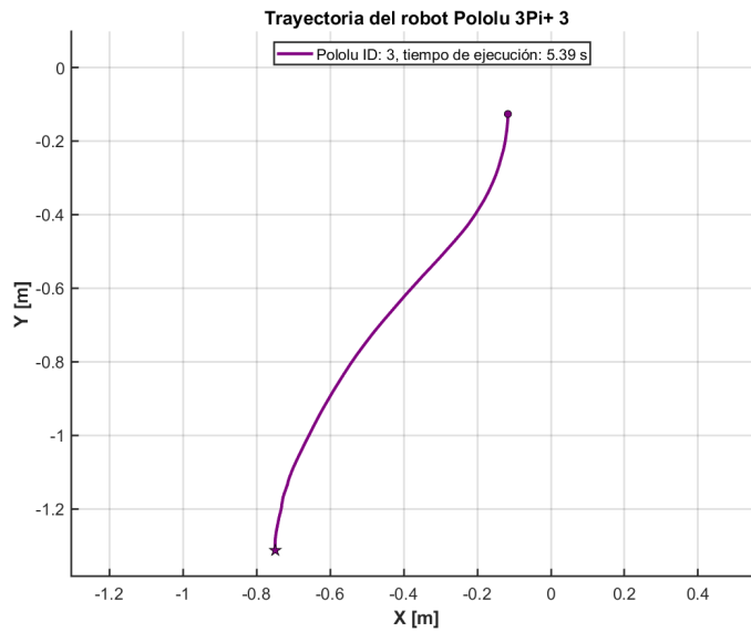
Figura 21. Trayectoria del robot Pololu 3Pi+ ejecutando el nodo controller_3pi para una meta estática
