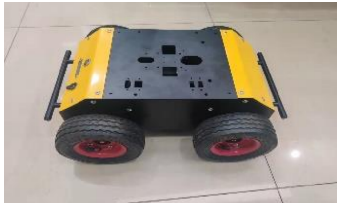
Figura 1. Robot móvil controlado por ESP32 usando micro-ROS
