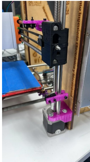
Figura 35. Implementación de nueva pieza de eje Z.
