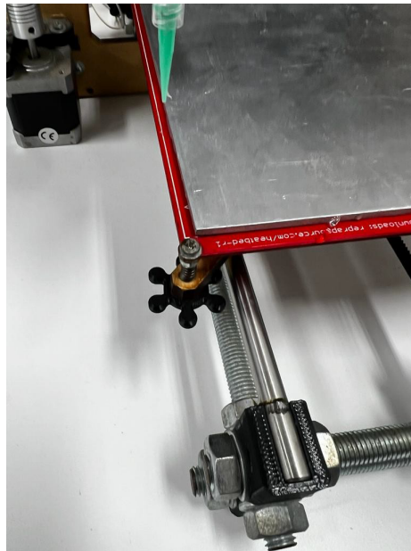
Figura 36. Tuercas para la calibración de superficie de impresión.
