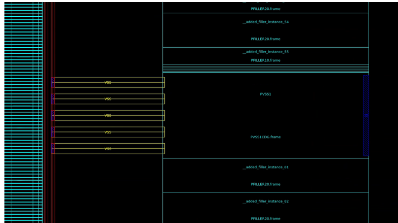
Figura 31. Detalle del resultado final del layout de la compuerta NOT
