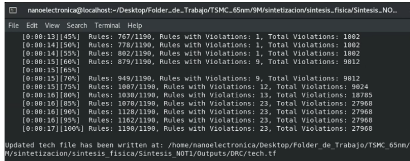
Figura 20. Errores DRC con corrección de librerías DB y tecnología de 9 capas de metal
