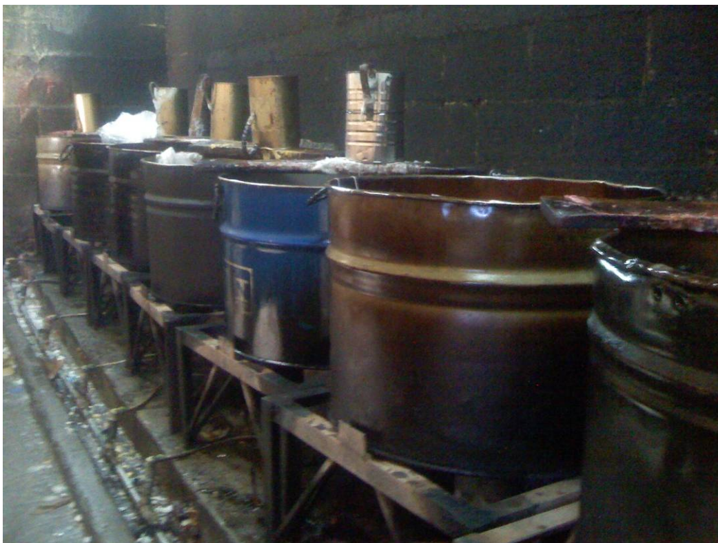
Gráfico número 4. Tanques para derretir la parafina.
