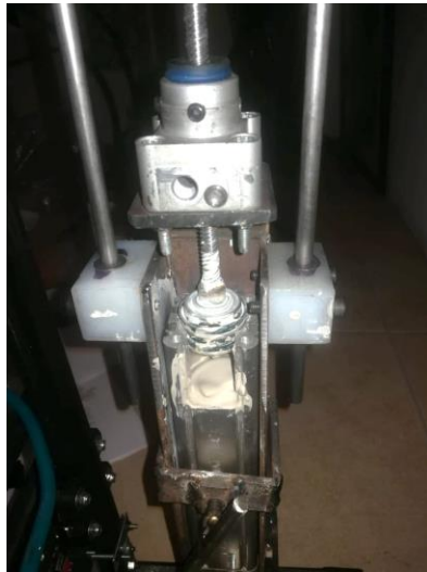
Ilustración 25: Extrusor con rebalse
