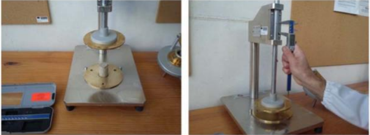
Ilustración 3: Medición de plasticidad con el método de Pfefferkorn
