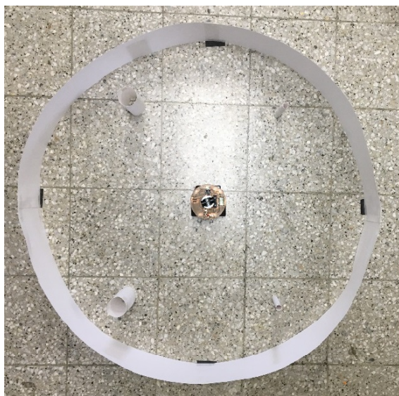
Figura 71: Prueba de detección de cilindros de 1.5cm y 5cm dentro de la barrera circular.
