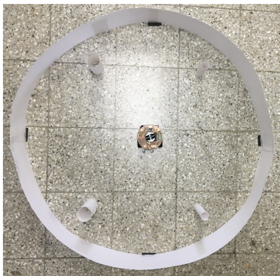
Figura 72: Prueba de detección de cilindros de 3cm y 5cm dentro de la barrera circular.
