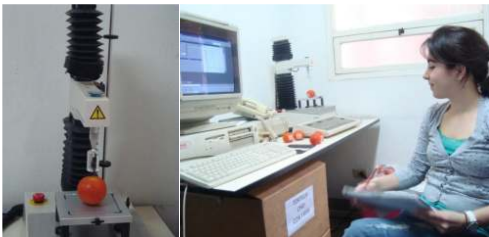
Fotografía no. 10: Penetración
