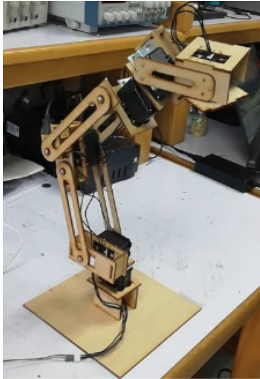
Figura 3: Segundo prototipo con 6 actuadores AX12-A
