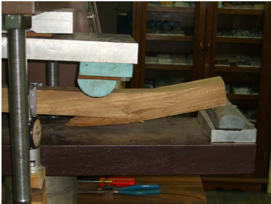
Figura 5.24. Prueba de flexión estática del Pucte.
