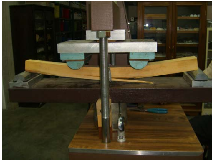
Figura 4.15. Ensayo de flexión para el Tempisque.
