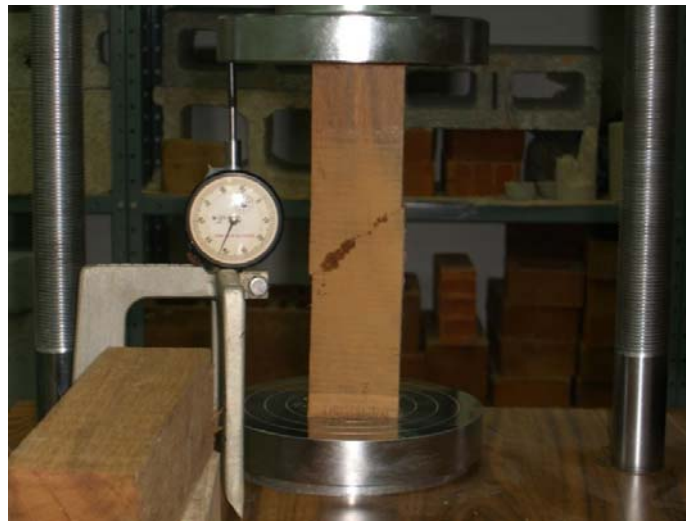
Figura 4.12. Prueba de compresión paralela a la fibra en Pucte. (Falla de Corte)
