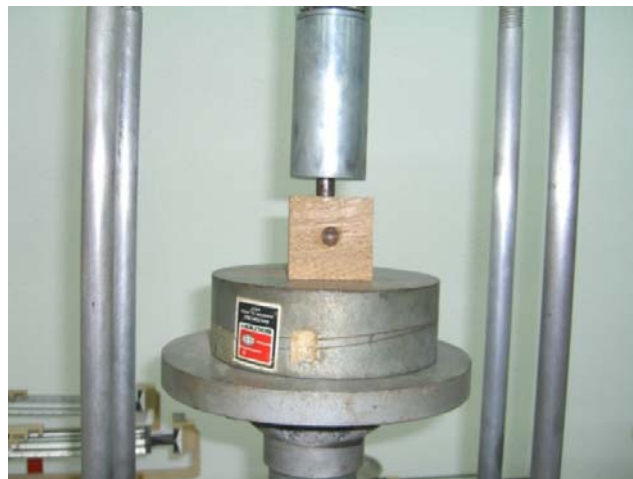
Figura 4.14. Ensayo de dureza en una pieza de Lloro-sangre.
