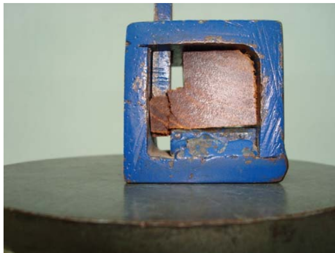
Figura 4.16. Ensayo de corte sobre una probeta de Jobillo.
