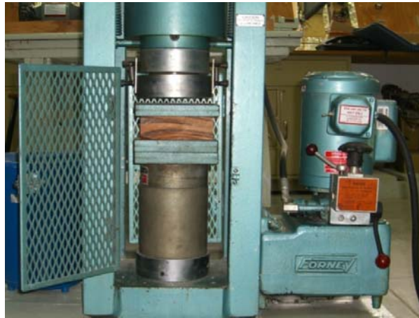
Figura 4.13. Ensayo de compresión perpendicular a la fibra en Jobillo.
