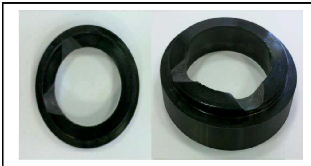
Figura No. 44 Dispositivo desalojador (stripper) con 5 días de uso
