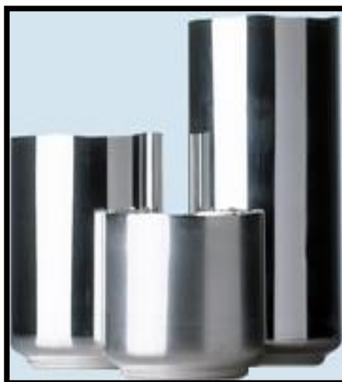
Figura No. 8 Etapas de estirado de bote dentro del equipo
