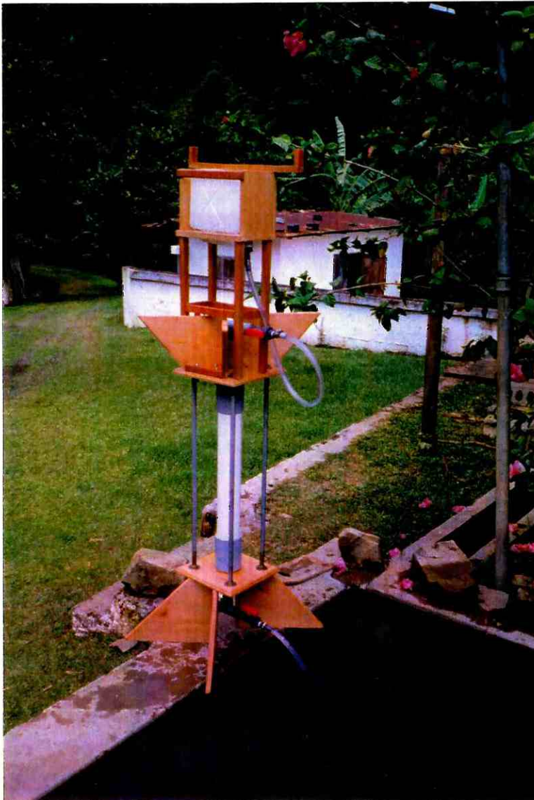
Figura 11. El intercambiador regenerándose, con flujo en sentido inverso al tratamiento de agua.
