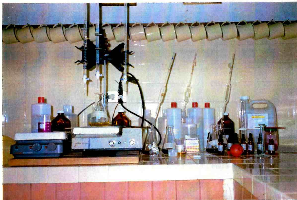
FIGURA 7. Equipo utilizado en las determinaciones de dureza, carbonatos, bicarbonatos y pH.
