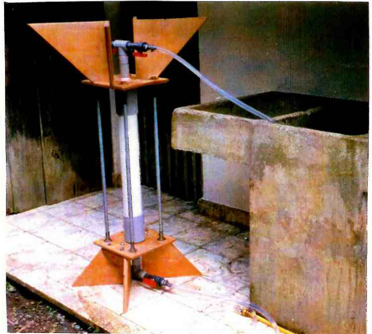
Figura 10. Expansión de la resina del intercambiador, con flujo de abajo hacia arriba.
