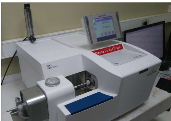
Ilustración 17. Equipo de TGA Mettler Toledo. Puede observarse el brazo blanco para montaje de la muestra.
