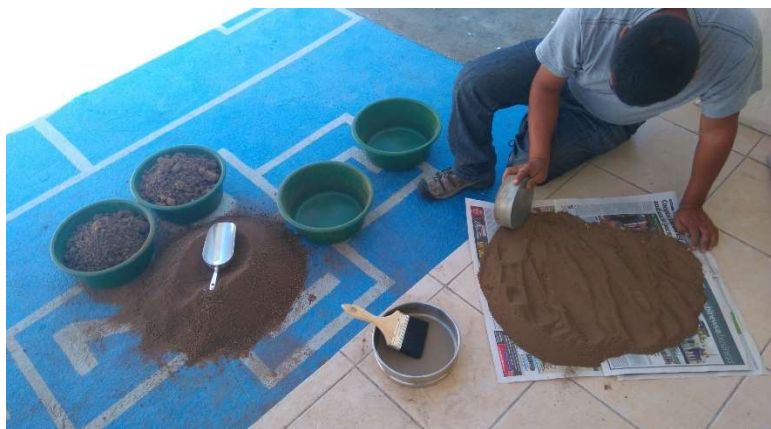
Ilustración 11. Tamizado de muestras de arcilla con tamiz No. 200.
