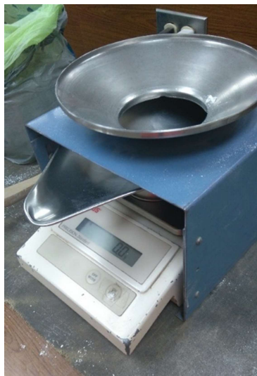
Ilustración 10. Balanza electrónica con embudo y recipiente para pesar la cal y evitar la pérdida de material tamizado.
