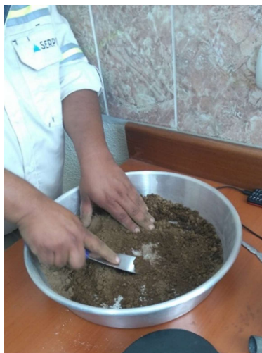
Ilustración 12. Muestra de arcilla mezclándose luego de haberle agregado agua para que alcance su humedad óptima.
