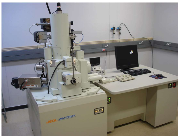
Ilustración 7. Equipo de microscopio electrónico de barrido JEOL JSM-7500F.
