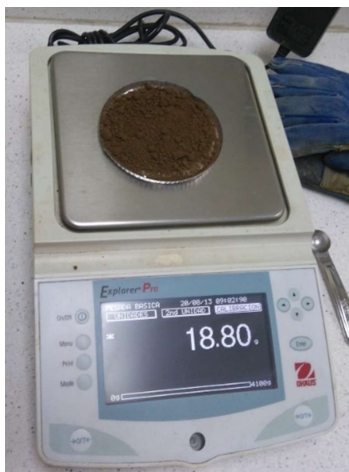
Ilustración 14. Medición de masa de una de las muestras de arcilla en una balanza analítica Ohaus Explorer Pro.
