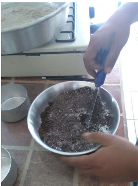
Ilustración 13. Mezclado de muestra de arcilla con cal hidratada especial Horcalsa en un 4%.
