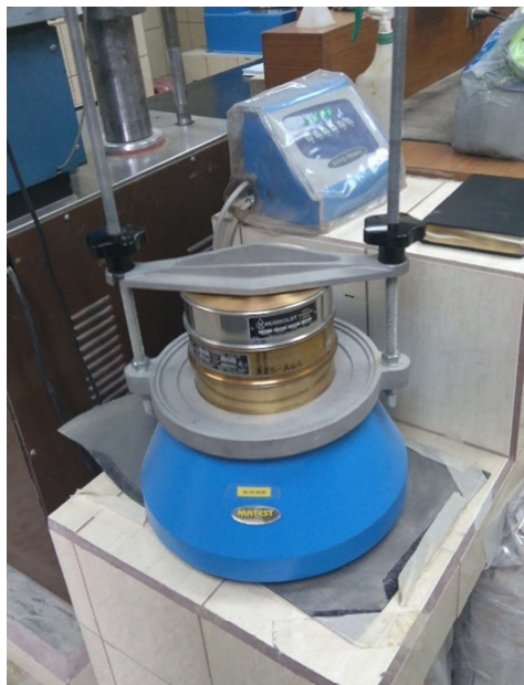
Ilustración 9. Serie de tamices montados sobre la tamizadora electromagnética.
