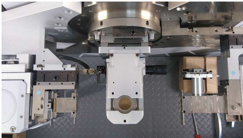
Ilustración 15. Muestra de arcilla montada en equipo Empyrean de PANalytical previo a su análisis.
