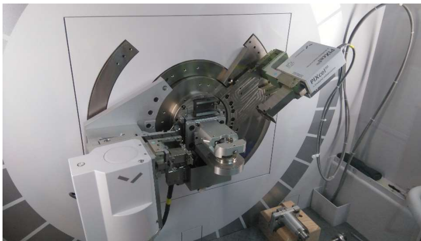
Ilustración 16. Equipo de DRX Empyrean de PANalytical. Puede observarse el goniómetro rotativo.
