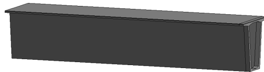
Figura 69: Vista 3D de dovela en el apoyo
