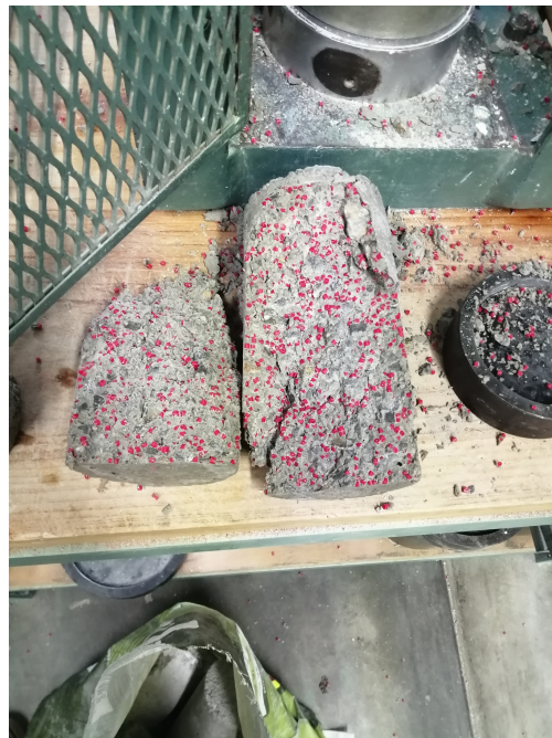
Figura 26: Ejemplo cilindro ensayado en el laboratorio de Ingeniería Civil Fuente: Elaboración propia.
