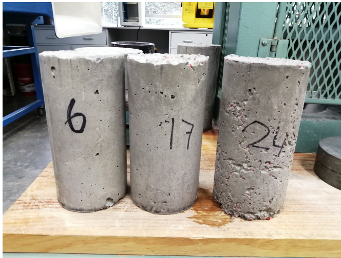
Figura 25: Comparación entre cilindros de concreto entre el concreto convencional y concretos con agregado con 10% y 15%
