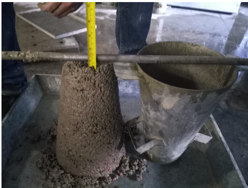
Figura 17: Ensayo de revenimiento de concreto con 15 % de agregado plástico Fuente: Elaboración propia.
