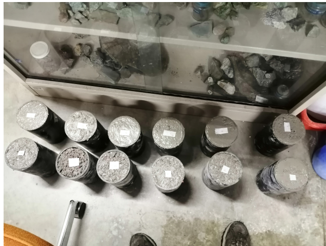
Figura 23: Moldes utilizados para mezclas de concreto Fuente: Elaboración propia.
