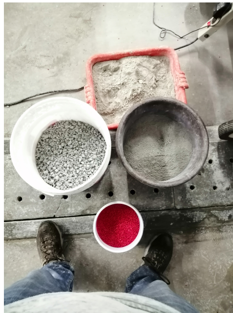
Figura 15: Dosificación utilizada para mezcla de concreto polimérico Fuente: Elaboración propia.
