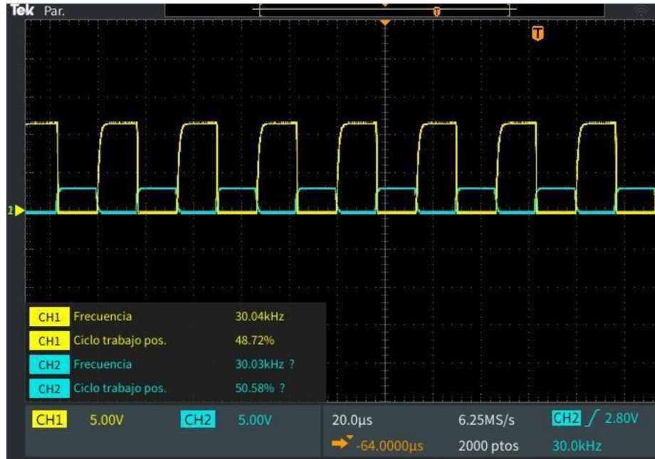
Figura 27. Comparación entre la señal de control y la señal amplificada del driver con MOSFET IRF540N. La señal azul es la generada con la Tiva C con una frecuencia de 30 kHz y un voltaje de 3.3 V de amplitud y la señal amarilla es la generada con el amplificador de voltaje de amplitud de 12 V
