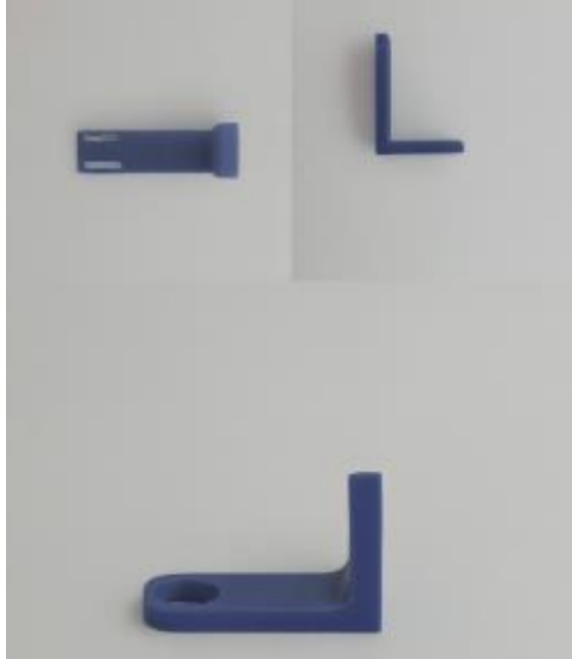
Figura 33. Soporte impreso en 3D para la colocación del sensor de temperatura en la punta de la pinza. La pieza fue fabricada en PLA con una resolución de 0.04 mm. Se observan el orificio circular destinado al montaje del sensor y las ranuras laterales para el ajuste y sujeción en la estructura de la pinza
