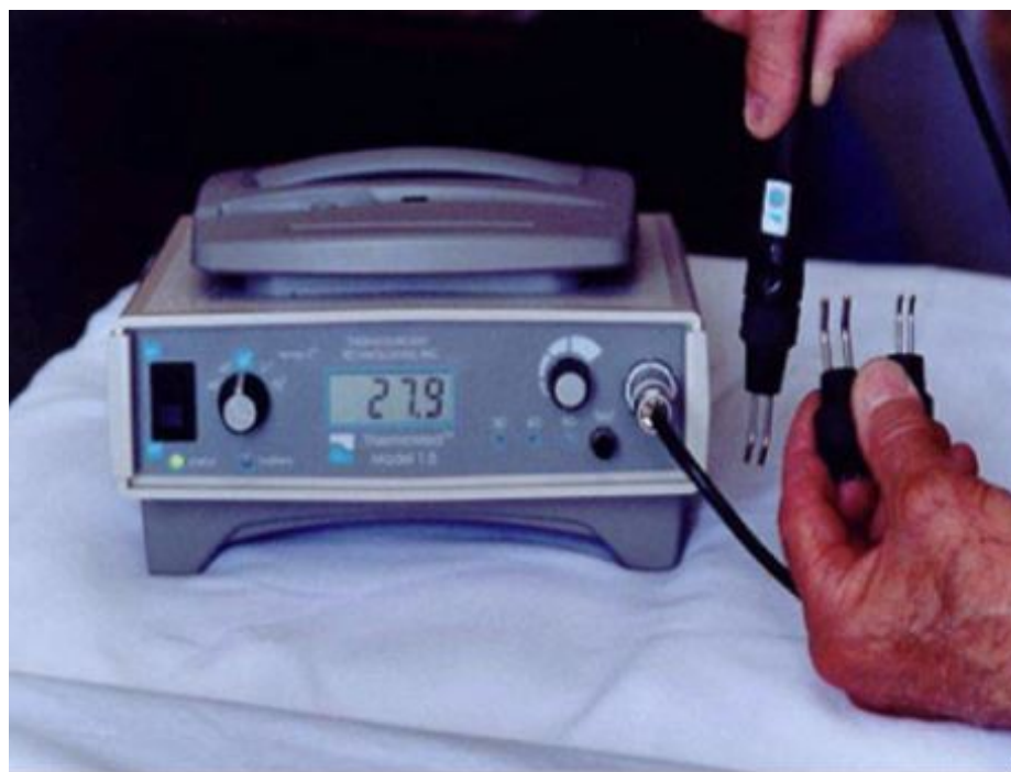
Figura 7. Dispositivo ThermoMed™ Modelo 1.8, utilizado para la aplicación de termoterapia por radiofrecuencia en el tratamiento de la leishmaniasis cutánea [64]
