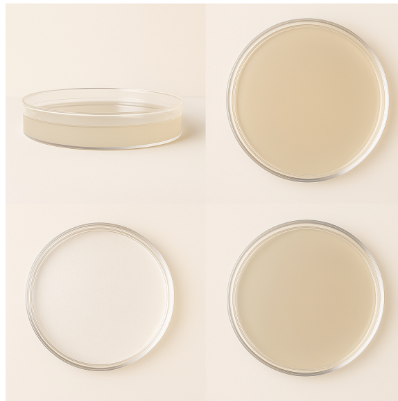
Figura 21. Preparación de agar al 2% en PBS vertido en placa de petri (altura de 3 mm) y solidificado a temperatura ambiente
