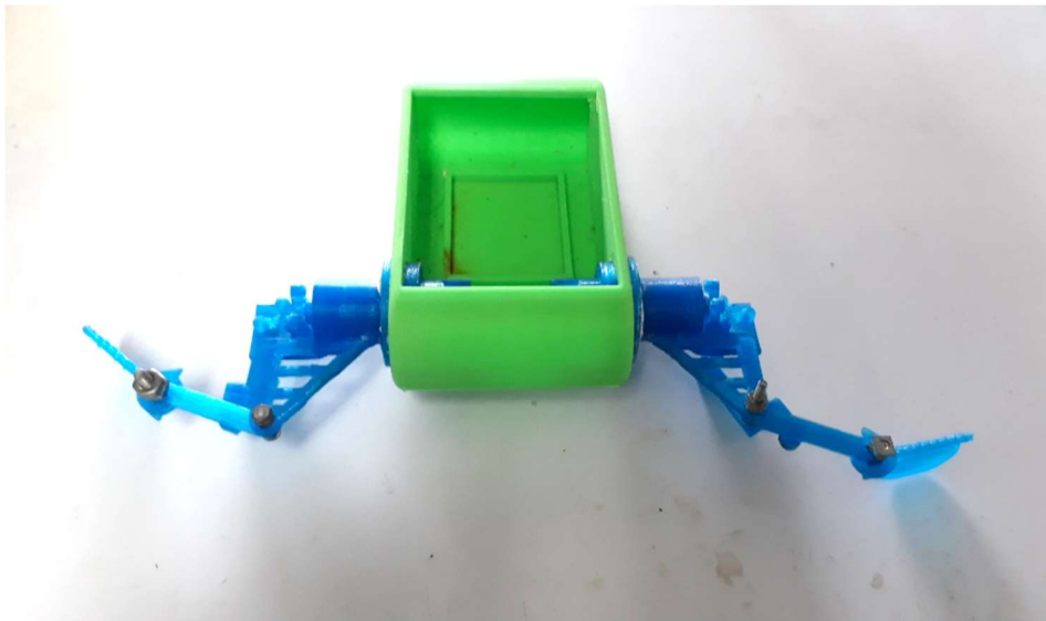
Figura 188 Prototipo con el diseño de mejor coeficiente de arrastre calculado en ANSYS.
