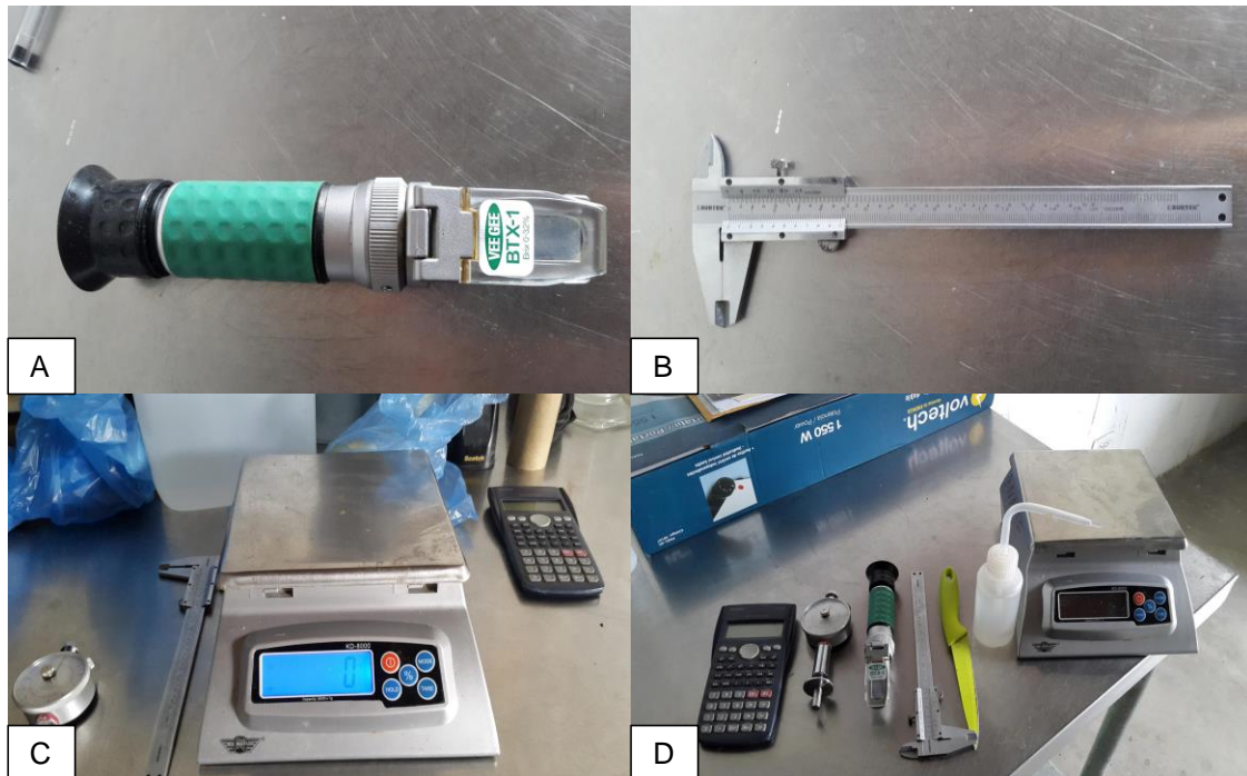
Figura 41. Equipo usado para las mediciones en los frutos del melocotonero. A: Refractómetro, para la medición de los grados brix. B: Vernier, para la medición de diámetro y altura de los frutos. C: Balanza electrónica, para la medición del peso. D: Todo el equipo utilizado.
