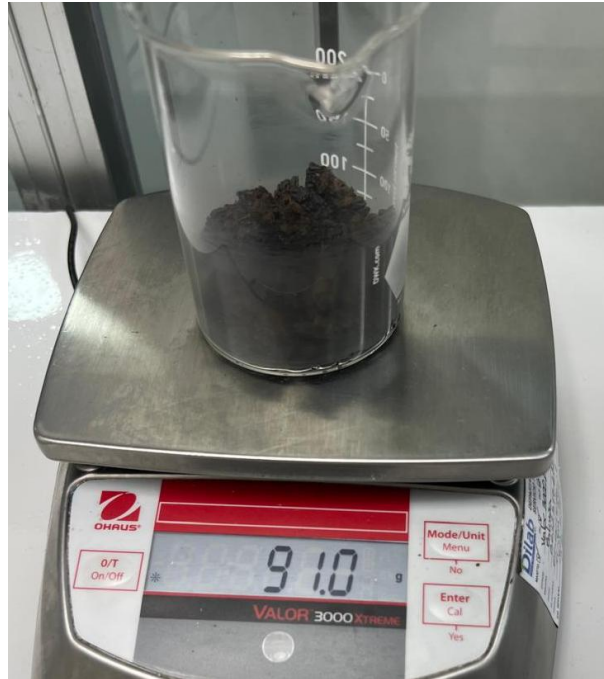
Figura 30. Biochar resultante del proceso de pirólisis de olote crudo
