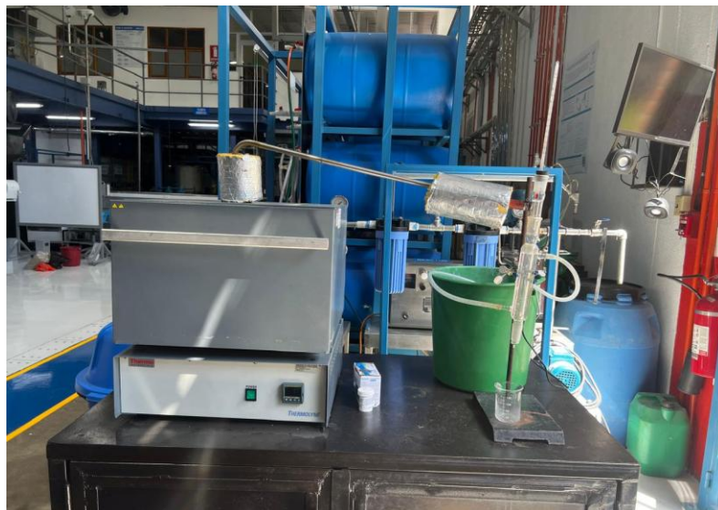
Figura 29. Sistema para llevar a cabo el proceso de pirólisis de olote crudo y olote cocido
