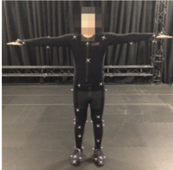
Figura 37: Ejemplo de participante con traje de OptiTrack adoptando una pose de calibración T-Pose [3]
