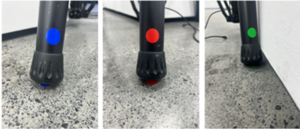
Figura 25: Patas del trípode de una de las cámaras, mostrando sus calcomanías correspondientes para determinar la posición exacta en la que se debe colocar
