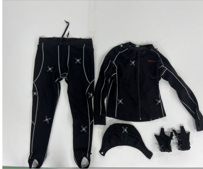
Figura 36: Traje de captura usado para las pruebas, incluye un sombrero, una chaqueta, un pantalón y un par de guantes. La fotografía fue tomada después de las pruebas, los marcadores siempre se deben colocar cuando el participante ya tiene puesto el traje
