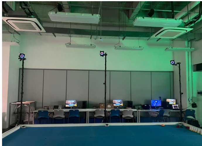
Figura 27: Diferencia de altura entre cámaras centrales (3 m) y laterales (2.6 m)
