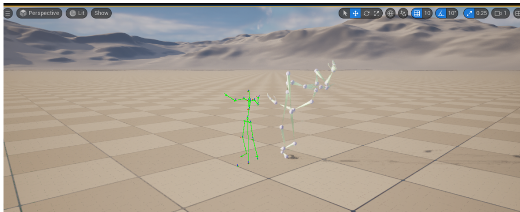
Figura 62: Comparación entre la información de movimiento recibida de Motive (esqueleto verde) con los movimientos realizados por el personaje (esqueleto blanco)
