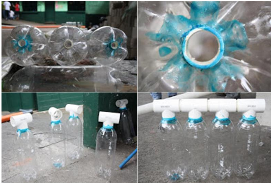
Figura 35. Proceso de ensamblaje del Eco-Muro.
