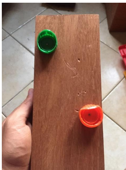
Figura No.62. Tapadera de botellas PET para la formación de acople entre tejas.
