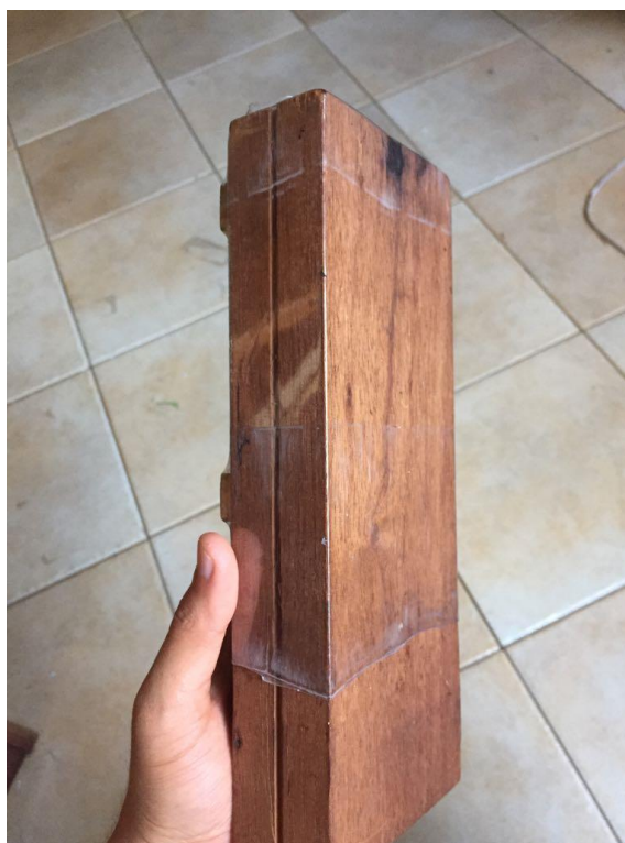
Figura No.57. Formación de teja rectangular posterior en el molde de madera
