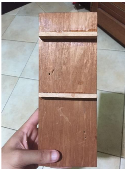
Figura No.61. Reglas de madera verticales para la formación de acople entre tejas.
