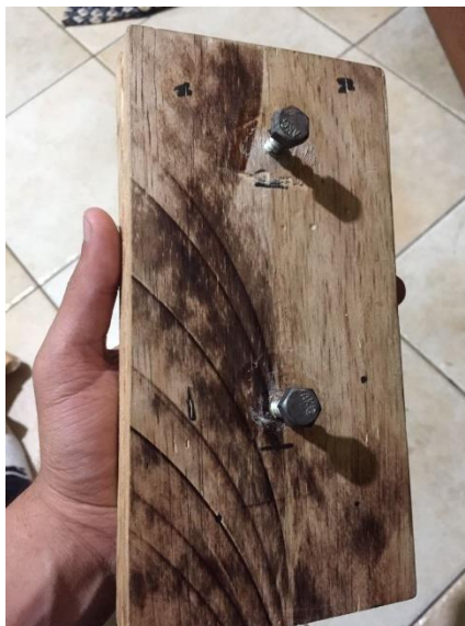
Figura No.64. Tornillos con cabeza 13 mm. para la formación de acople entre tejas.
