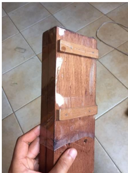
Figura No.58. Formación de teja rectangular frontal en el molde de madera
