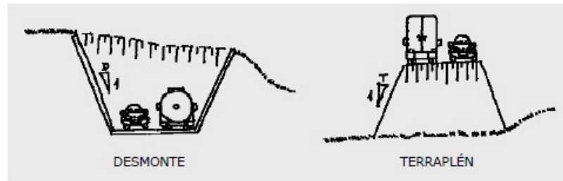
Figura 2: Diferencia gráfica entre desmonte y terraplén.
