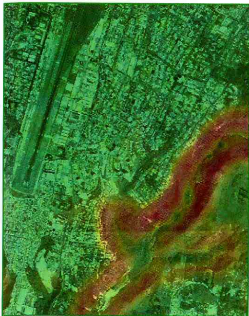
Mapa de Pendientes, utilizando método de INTERPOLACIÓN BILINEAR.
