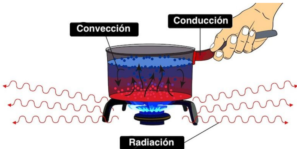
Figura 6. Tipo de transferencias de calor.
