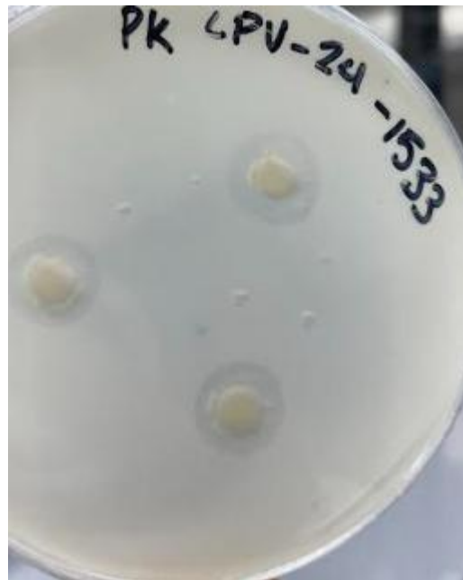
FIGURA 5: RESULTADO POSITIVO PARA LA PRUEBA DE SOLUBILIZACIÓN DE CALCIO
