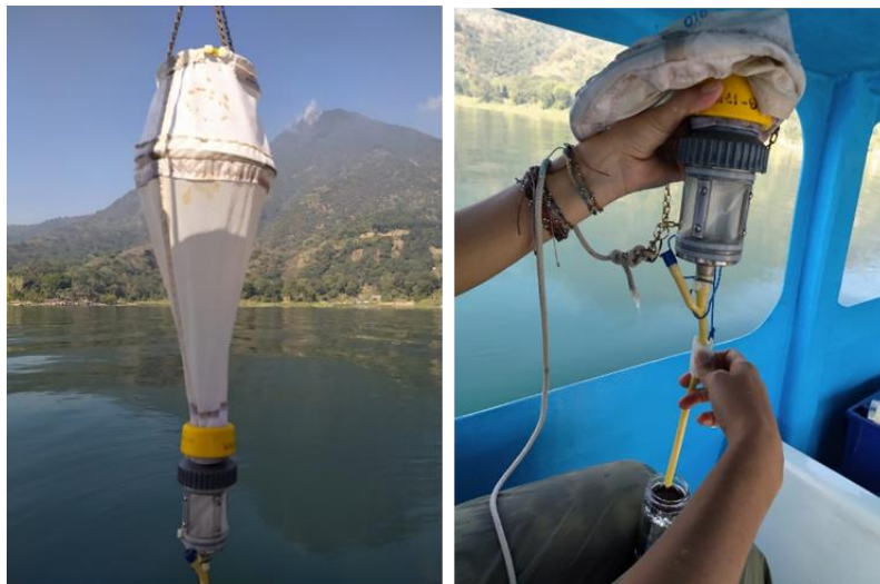
Figura 24. Red de Nanoplancton con porosidad de 25um para recolección de muestras en el lago de Atitlán
