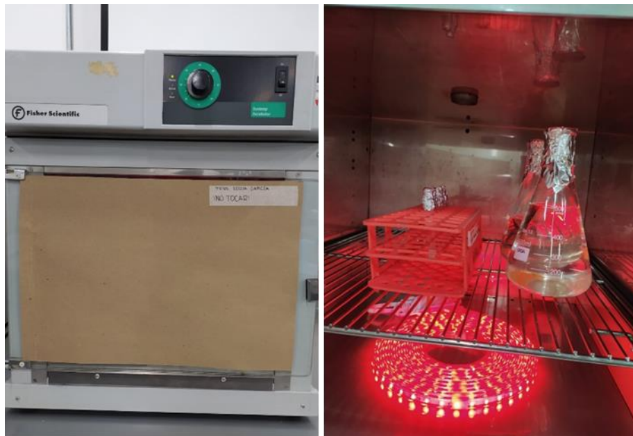
Figura 28. Sistema de incubación para crecimiento con condiciones controladas (temperatura 22°C, fotoperiodos 12:12 horas luz-oscuridad) con luz roja tipo regleta, en el laboratorio de Procesos Bioindustriales de la Universidad del Valle de Guatemala
