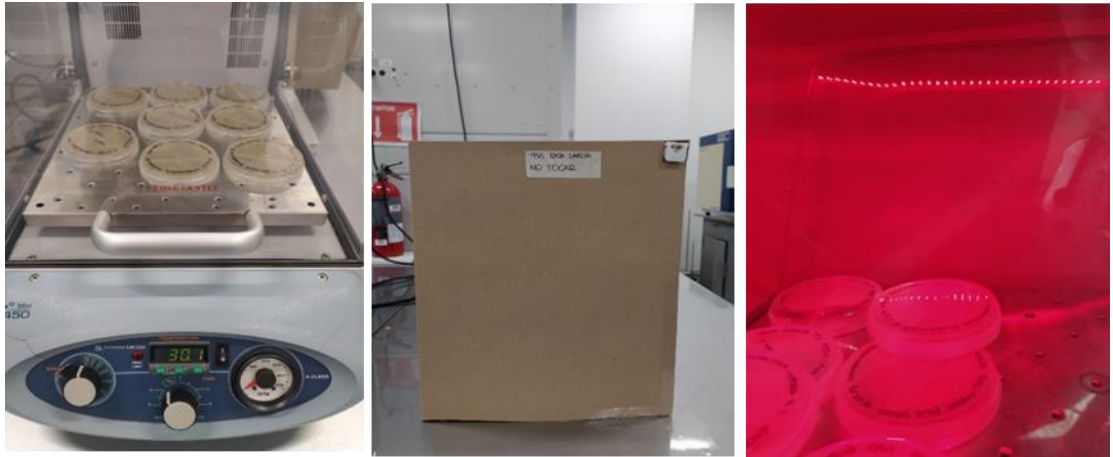
Figura 27. Sistema de incubación para crecimiento con condiciones controladas (temperatura 22°C, fotoperiodos 12:12 horas luz-oscuridad) con tira de luz roja led en el laboratorio de Procesos Bioindustriales de la Universidad del Valle de Guatemala
