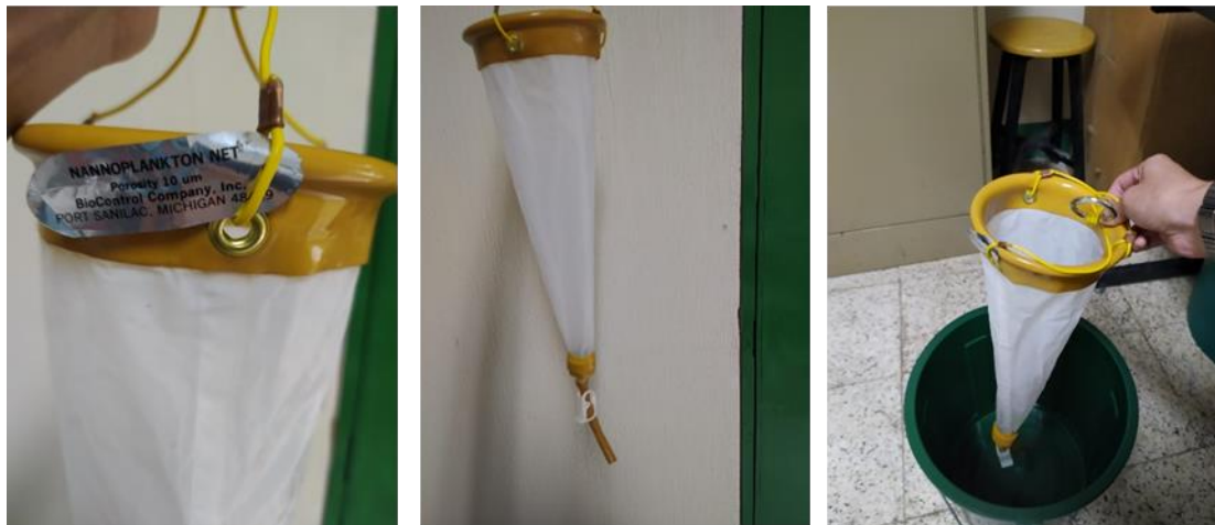
Figura 26. Red de Nanoplankton con porosidad de 10 \mu m para concentración de muestras del lago de Atilán
