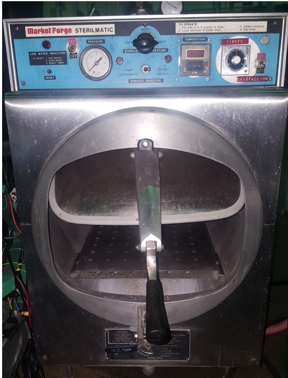
Figura 117: Autoclave utilizado para esterilización de cristalería.
