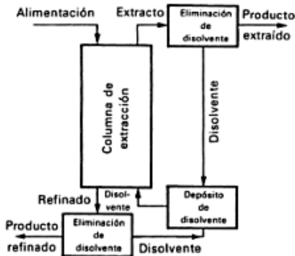
Figura 4: Extracción líquido-líquido por contacto continuo, con recuperación del disolvente
