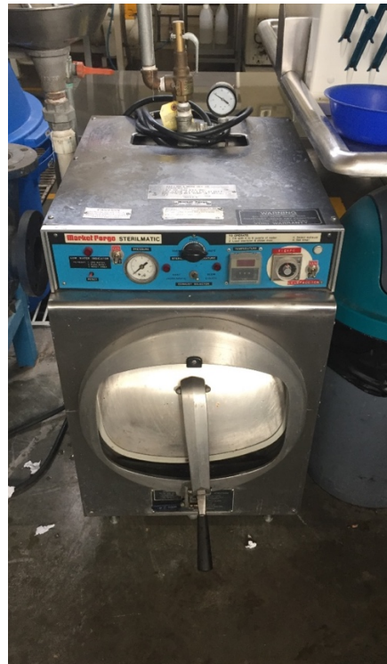
Figura 121: Autoclave utilizado para esterilizar el caldo de fermentación
