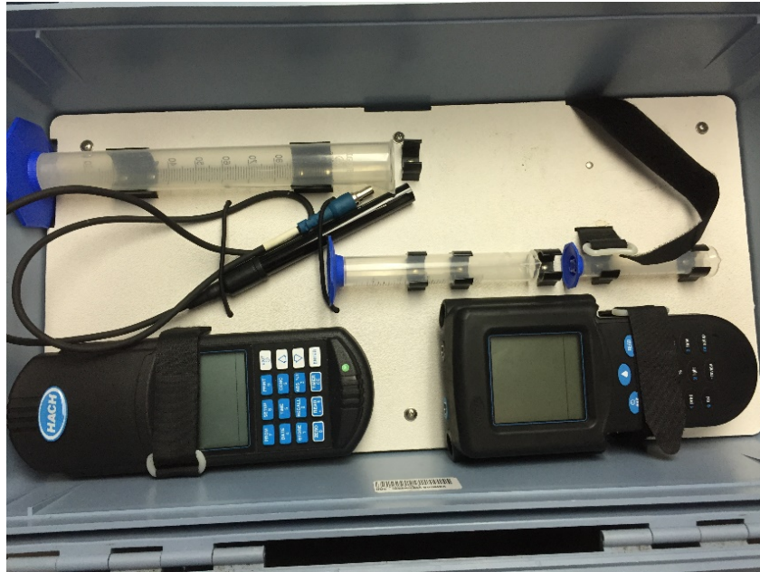
Figura 124: Equipo HACH utilizado para propiedades fisicoquímicas
