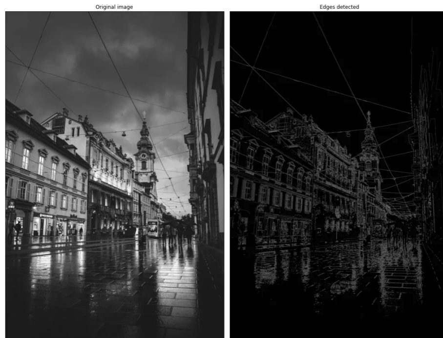
Figura 4.5: Imagen con detección de bordes mediante algoritmo de Canny Edge.
