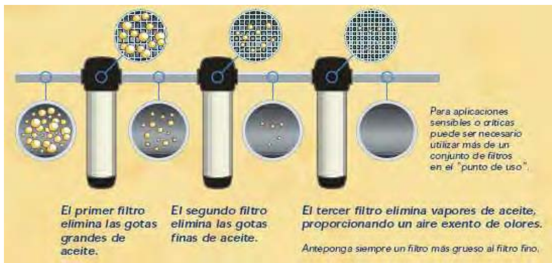
Figura 1: Tipos de filtros la eliminación de impurezas suspendidas en el aire comprimido (según IR)
