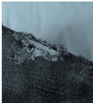
Ilustración 28: Tela de cabestrillo que falló
