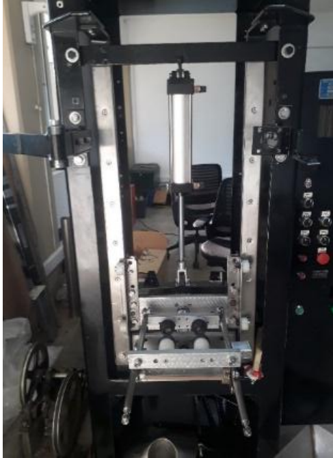
Figura 57: Actuador y halador instalados
