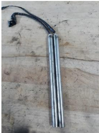
Figura 80: Resistencias de cartucho en buen estado
