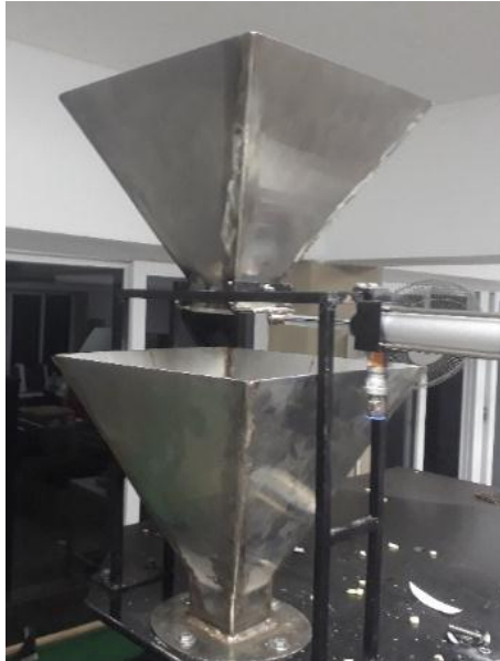
Figura 67: Instalación de tolvas
