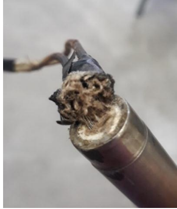
Figura 15: Resistencia de cartucho con alambre expuesto
