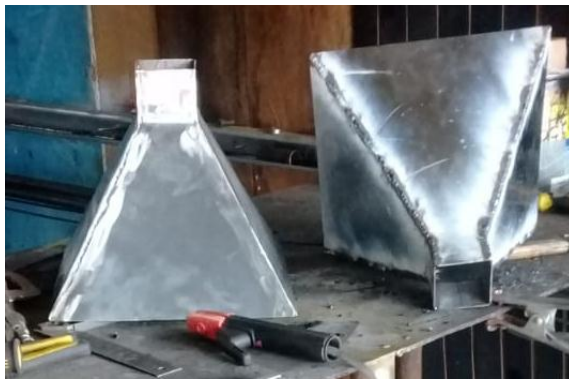
Figura 58: Fabricación de tolvas
