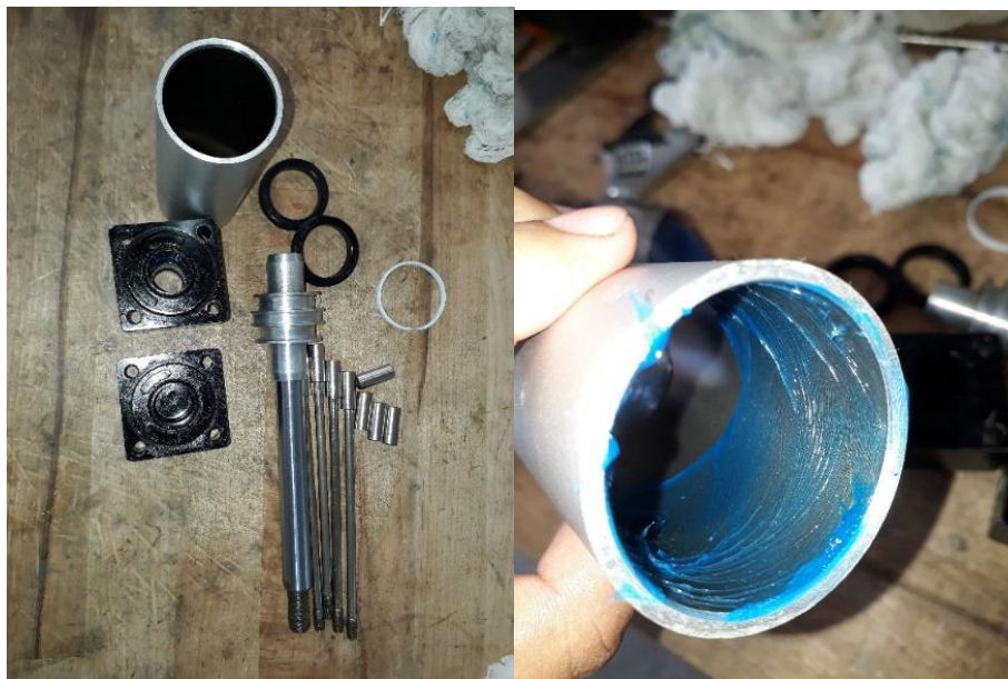
Figura 47: Mantenimiento cilindro AIRPRIME
