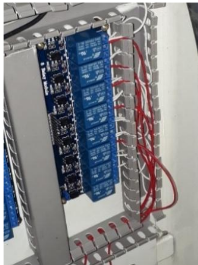
Figura 76: Conexión de salidas de relés
