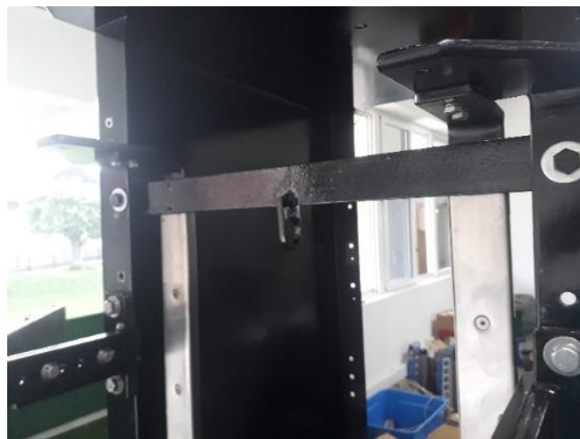
Figura 54: Instalación de acople para fijación trasera
