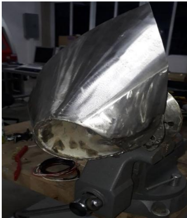
Figura 66: Cuello formador con superficie pulida
