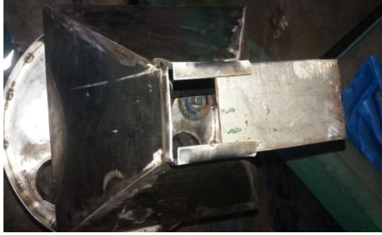
Figura 59: Fabricación de compuerta de tolva de grano
