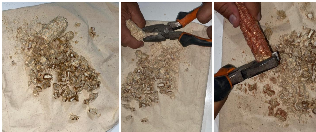
Figura 3. Corte de raquis con alicate de corte diagonal
