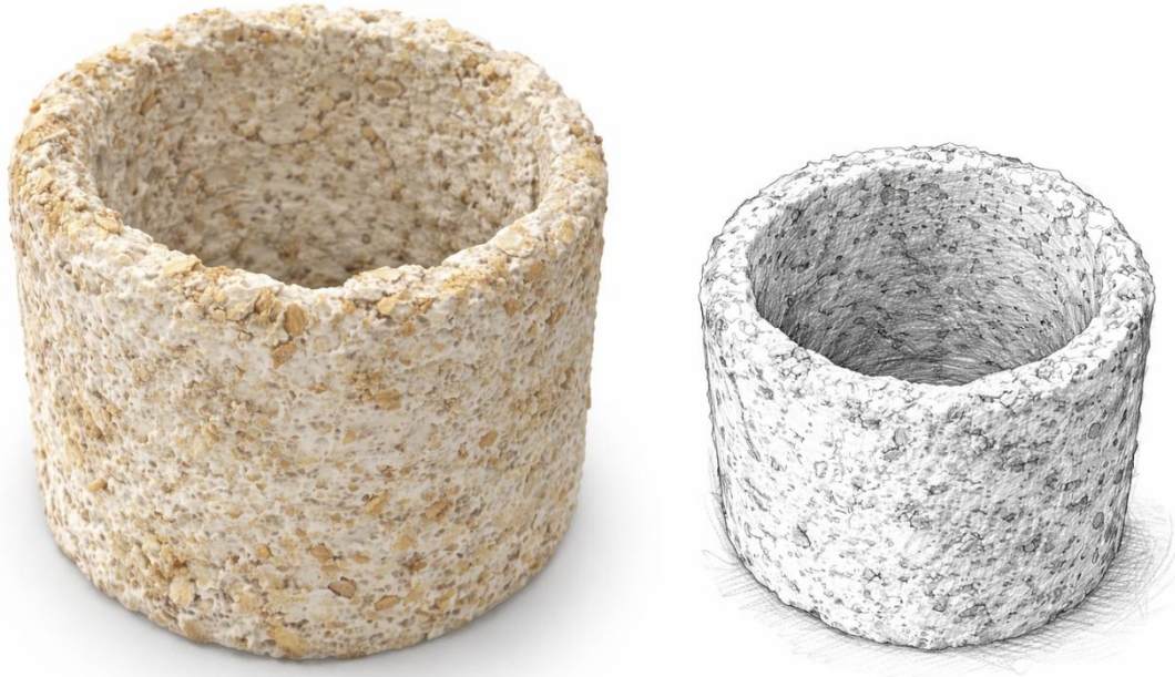
Figura 31. Forma 1 (cilíndrica) de empaque interior de micelio y raquis de maíz
