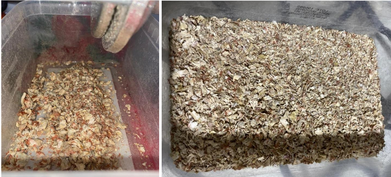
Figura 17. Proceso de molido de raquis
