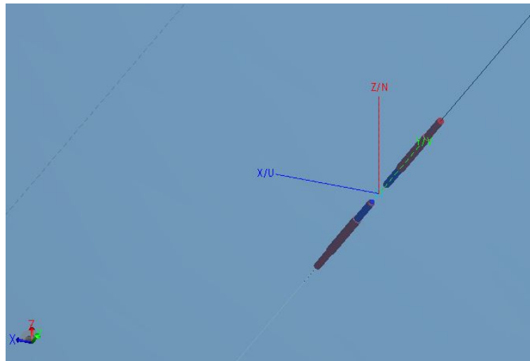
Figura XI.14: Diseño del dipolo terminado en CAD Feko.
