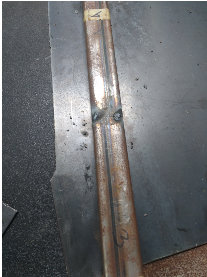
Figura XII.33: Puntos de soldadura para unión de piezas de la antena parabólica.
