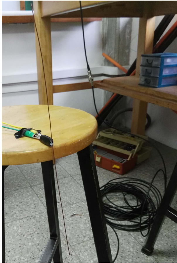
Figura XI.48: Antena dipolo conectada al generador de señales, a una altura de 65cm.
