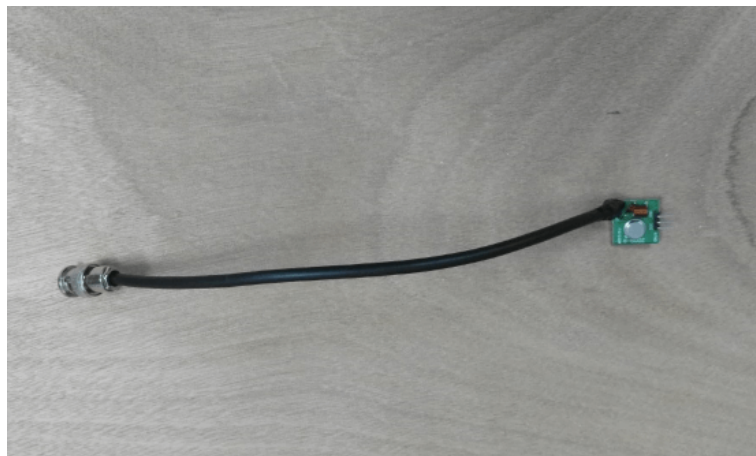
Figura XI.57: Transmisor RF con un conector BNC para acoplarse a la antena.
