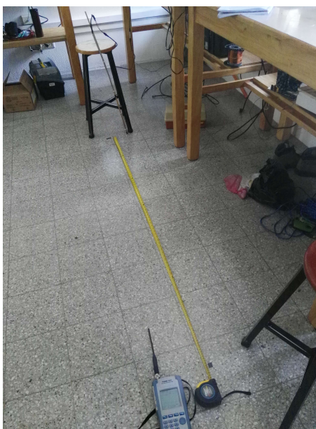
Figura XI.45: Espacio para medición de la señal emitida por la antena dipolo, se colocaron marcas en cada uno de los puntos en donde se realizaron las mediciones.
