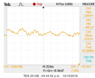
(h) Señal a 0.5m, medida con otra antena dipolo conectada a un osciloscopio.
