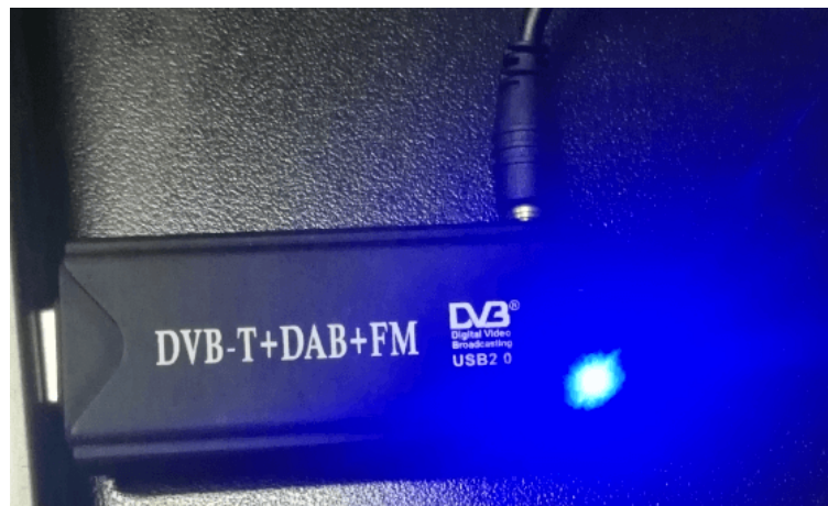
Figura XI.59: Placa SDR utilizada para visualizar la señal electromagnética generada con el emisor RF.
