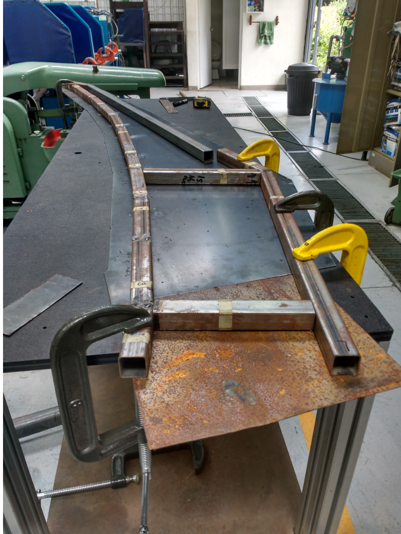
Figura XII.34: Unión de piezas del primer pétalo de la antena.
