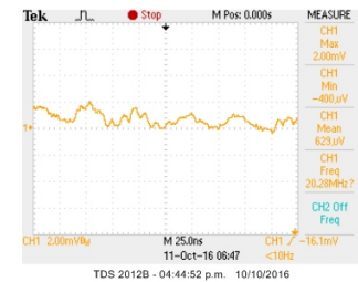
(i) Señal a 1m, medida con otra antena dipolo conectada a un osciloscopio.
