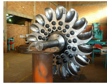
(c) Turbina para la generación de electricidad
