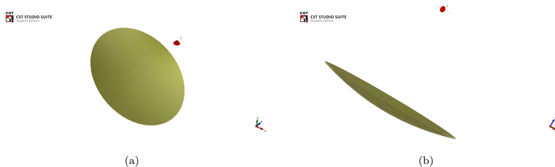
Figura XI.36: Reflector parabólico alimentado con una antena dipolo de media onda construido en CST Studio.
