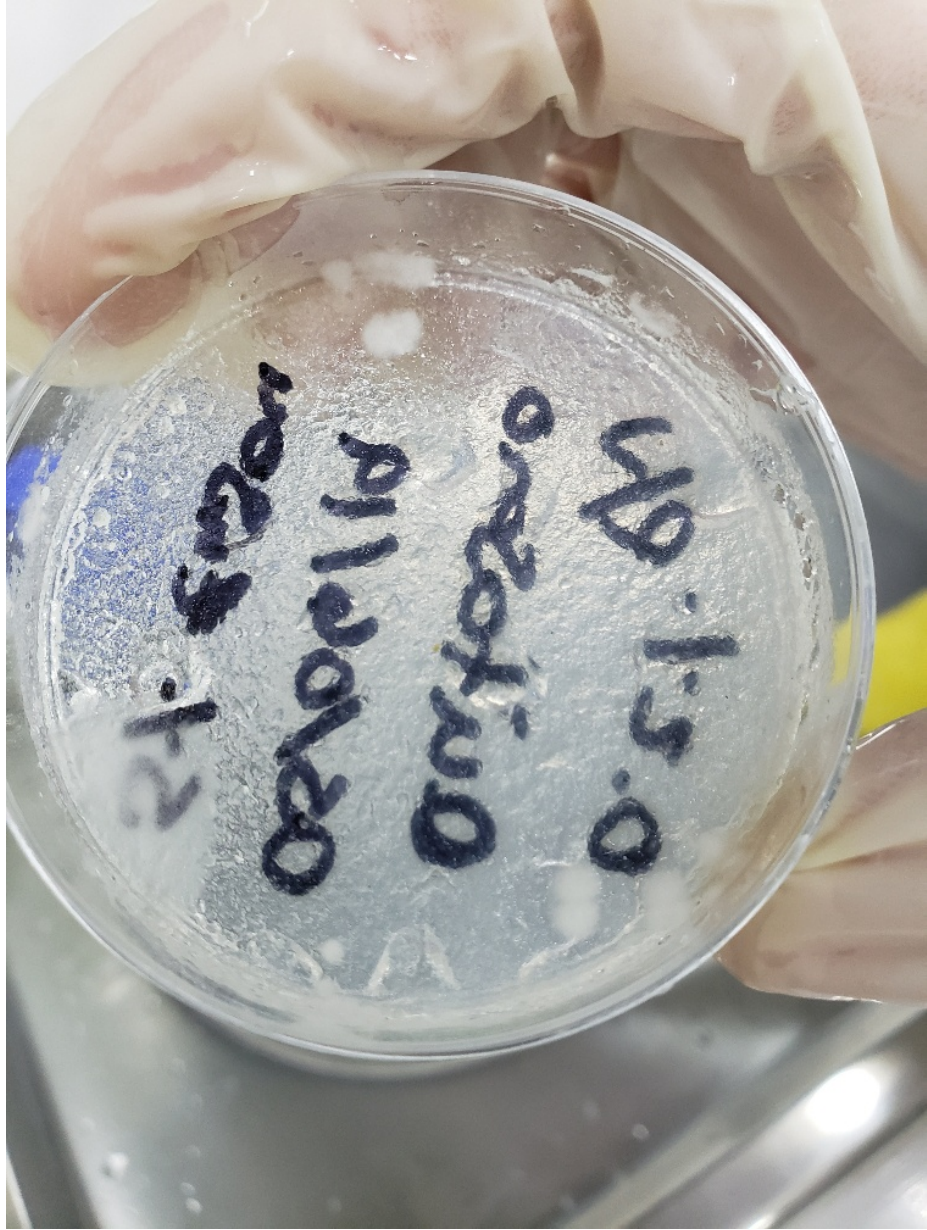
Figura 99: Cuarta prueba fallida de membrana. Gelificación más uniforme, pero aún imposible de manipular.
