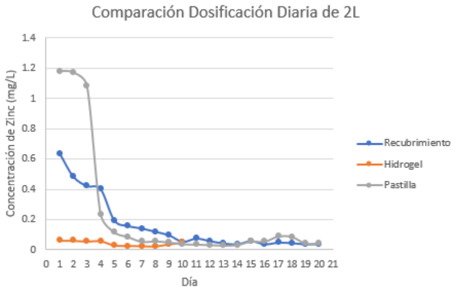
Figura 41: Comparación de la dosificación diaria de zinc para el patrón de uso de 2 litros
