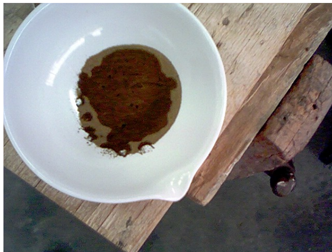
FOTO 22: PREPARACIÓN DE MATERIAL CON % HUMEDAD
