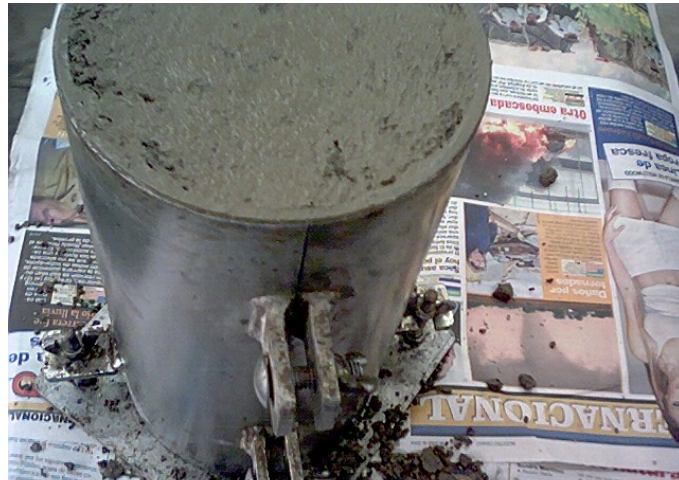
FOTO 36: CONCRETO EN CILINDRO
