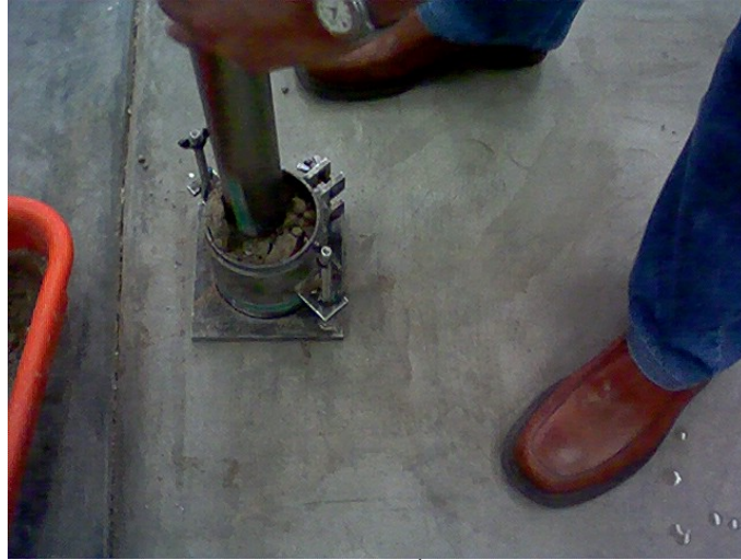
FOTO 12: COMPACTACIÓN CON MARTILLO
