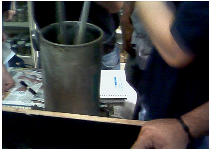
FOTO 35: COMPACTACIÓN DE MEZCLA DE CONCRETO
