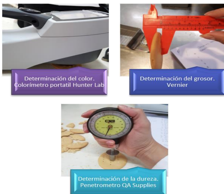
Figura 9. Determinación de las características físicas de las galletas María y las galletas realizadas en planta piloto
