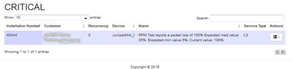
Figura 43. Listado de alarmas sobre eventos críticos.
