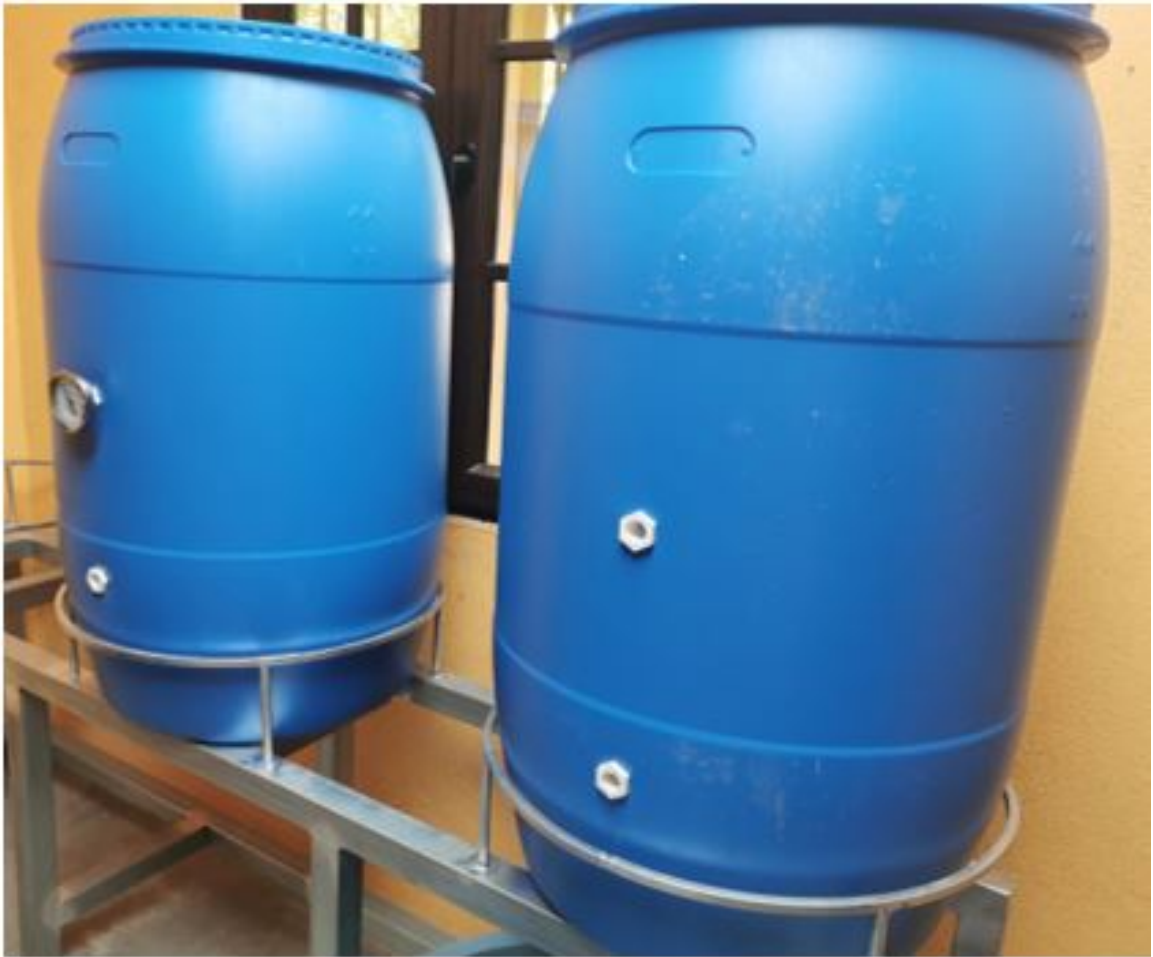
Figura 7.3: Biorreactores tamaño grande Posee un lector de temperatura, un pequeño chorro, una válvula de salida y un lector de presión en la tapa con cierre hermético.
