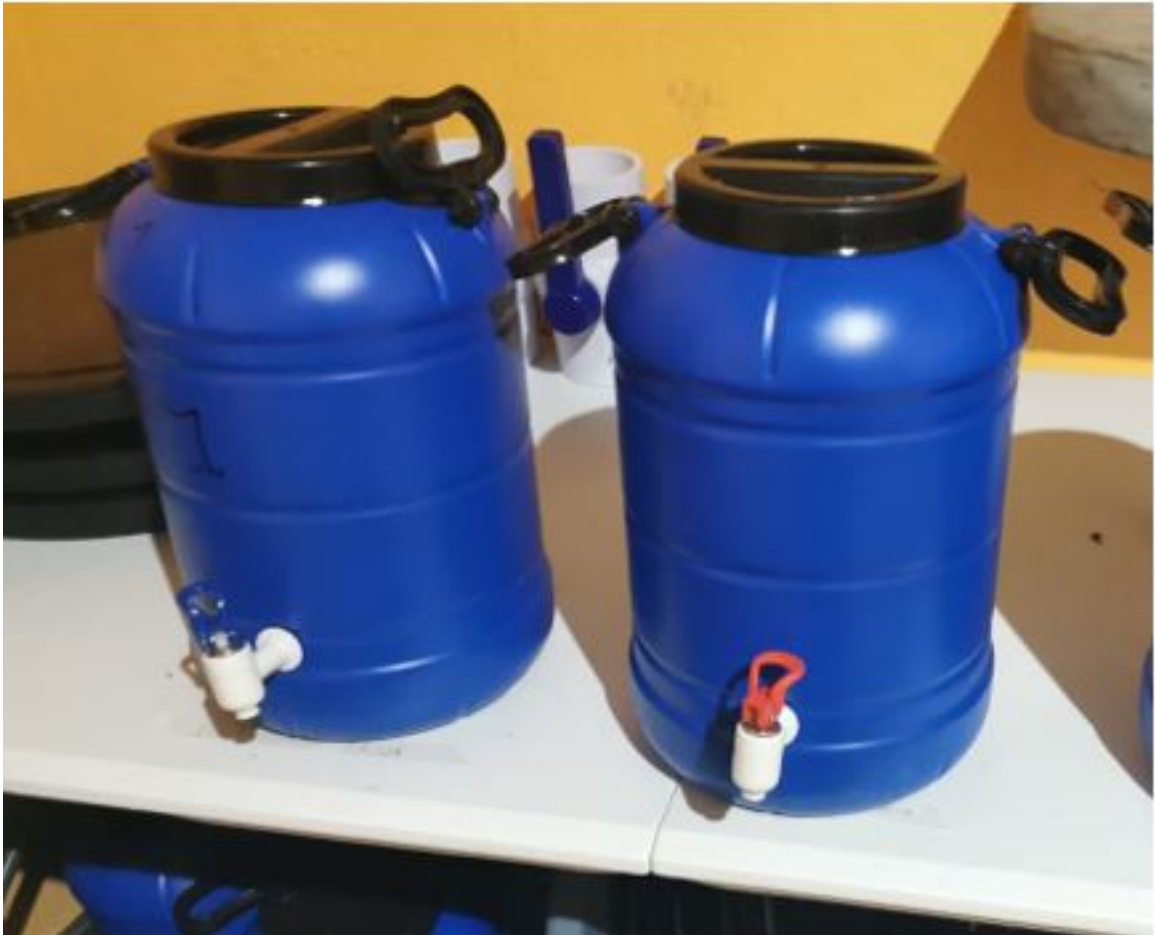
Figura 7.4: Biorreactores tamaño pequeño Posee un pequeño chorro y un cerrado hermético en la tapa.
