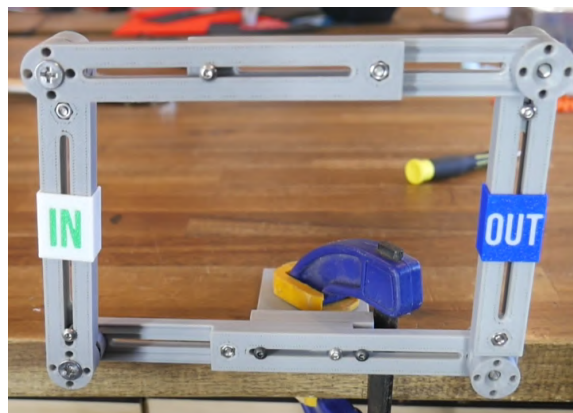
Figura 17. Método para cambio de eslabones propuesto por Teaching Tech [16]
