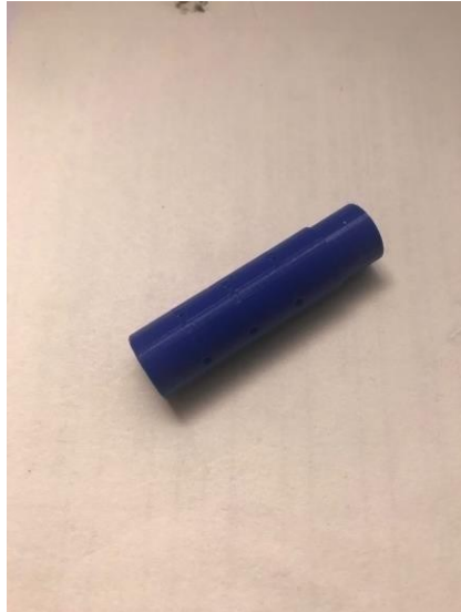
Figura 68: Modelo impreso en 3D del tubo para trampa de moscas
