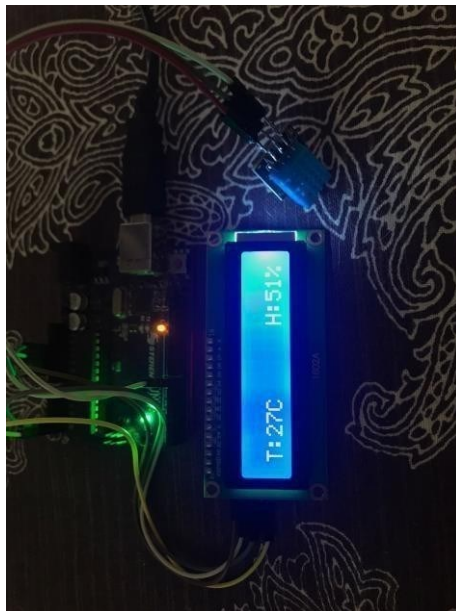
Figura 18: Montaje del display de temperatura y humedad
