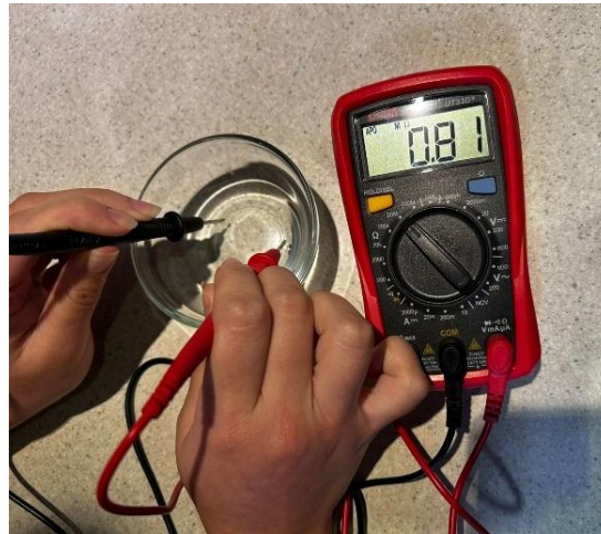
Figura 61. Medición de resistencia eléctrica para muestra de agua destilada recolectada de prueba #10
