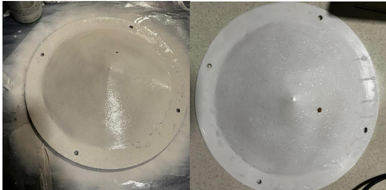
Figura 34. Recubrimiento con pintura blanca y prueba antiadherente de gotas
