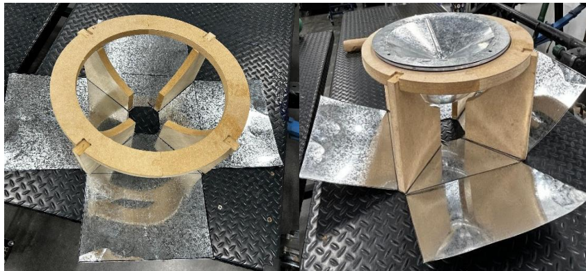
Figura 31. Fabricación y colocación de reflectores
