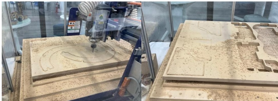
Figura 28. Maquinado de piezas de soporte en router CNC Shop
