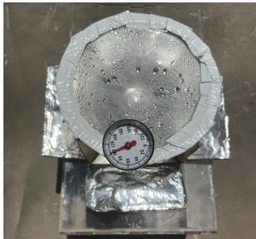
Figura 26. Prototipo de prueba sellado con cinta industrial
