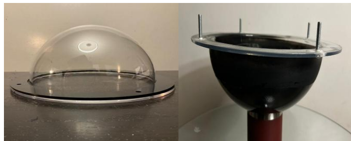
Figura 36. Domo evaporador original y modificado para pruebas de funcionalidad
