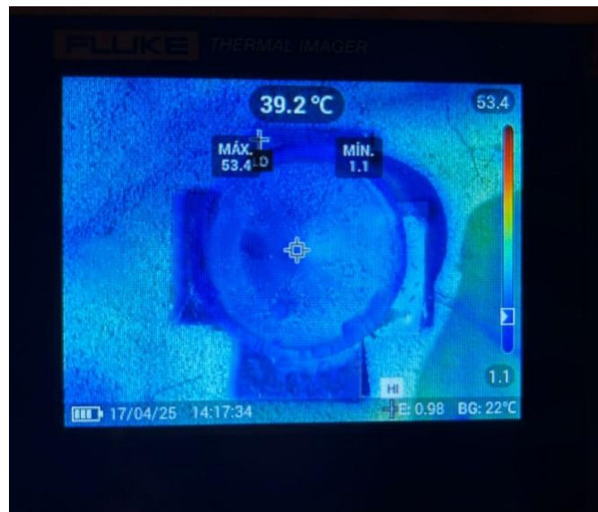
Figura 43. Temperatura superficial externa como evaporador de sistema prototipo experimental, prueba #4
