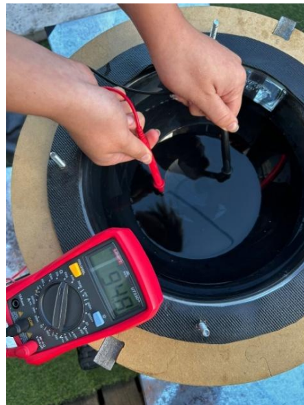
Figura 62. Medición de resistencia eléctrica para muestra de agua salada de prueba #10
