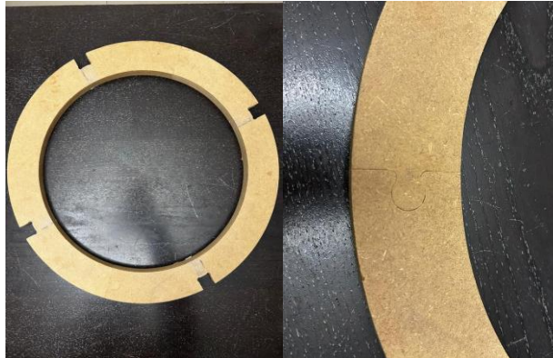
Figura 29. Unión de piezas de anillo de soporte
