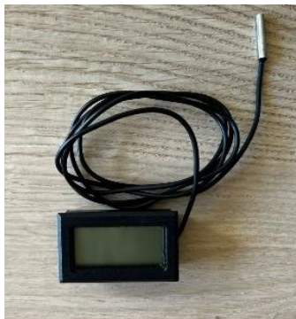
Figura 14. Termómetro electrónico para líquidos con sonda empleado para mediciones de temperatura de agua salada
