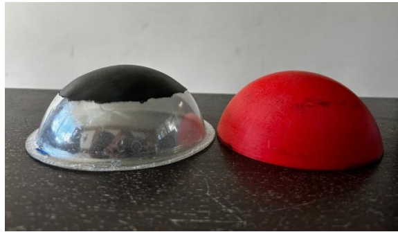
Figura 21. Domo evaporador termoformado y molde impreso en 3D
