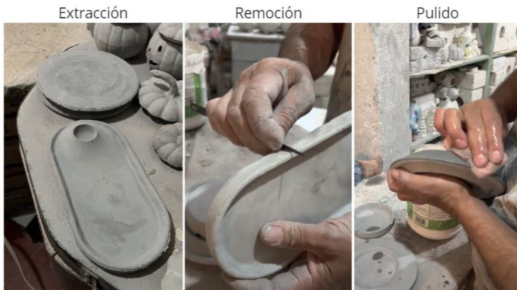
Figura 27. Extracción de pieza del molde, proceso de remoción de rebabas y pulido de pieza.
