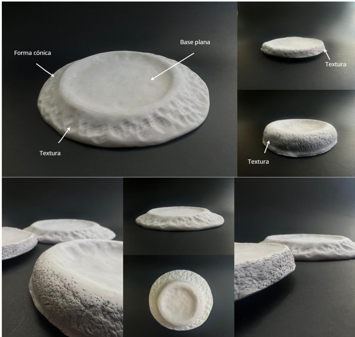
Figura 14. Primeros prototipos en arcilla que ayudan a verificar las formas propuestas en los bocetos, de igual forma la ubicación de texturas.
