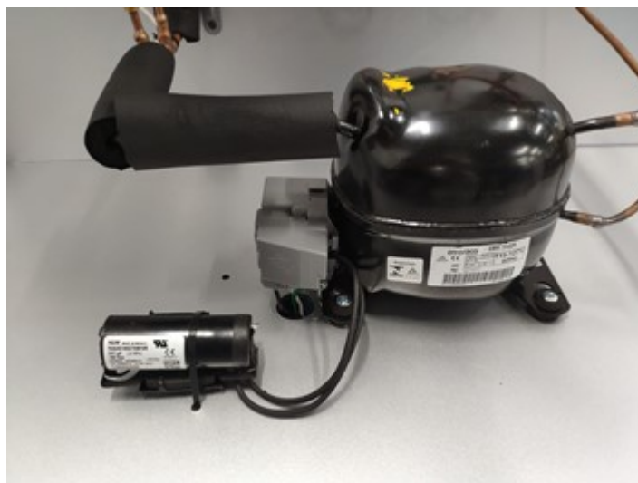
Figura 51: Instalación final del compresor y capacitor de arranque
