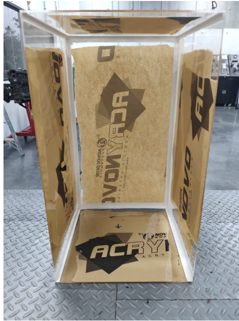
Figura 41: Caja interior del espacio refrigerado
