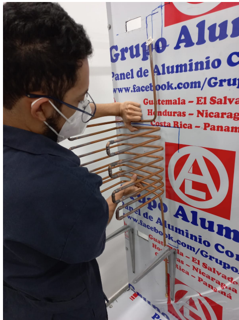
Figura 46: Prueba de instalación del evaporador
