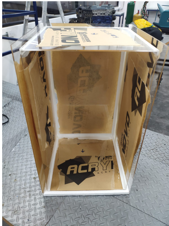
Figura 42: Ensamble de las partes del espacio refrigerado
