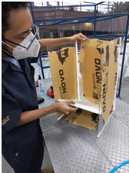
Figura 47: Instalación de piezas de poliestireno expandido en el espacio refrigerado
