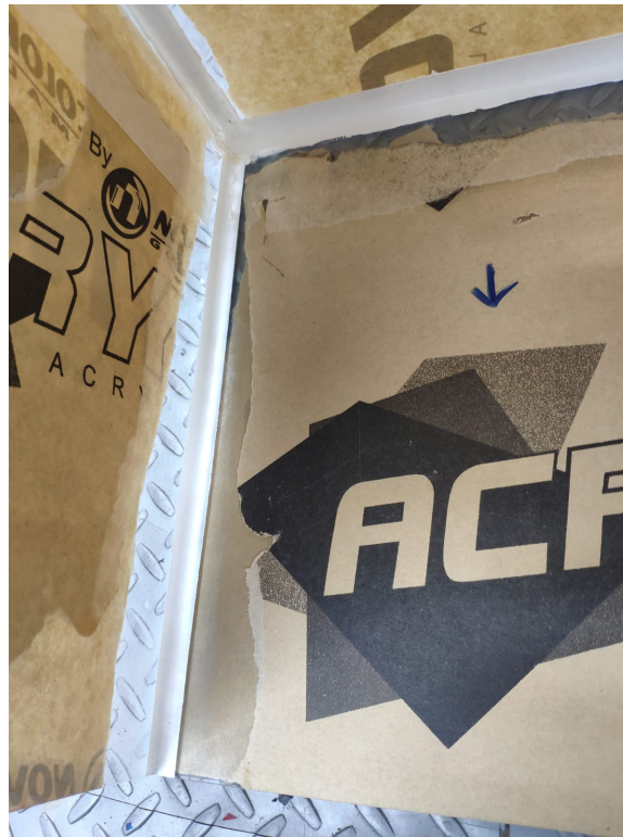
Figura 40: Unión de 90° de las piezas de acrílico con el uso del adhesivo Sikaflex 1a.
