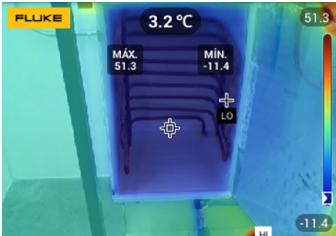
Figura 64: Registro de temperatura en el espacio refrigerado (termografía)
