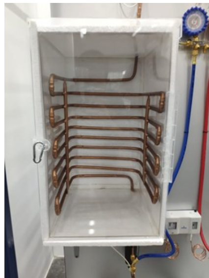
Figura 49: Espacio refrigerado final
