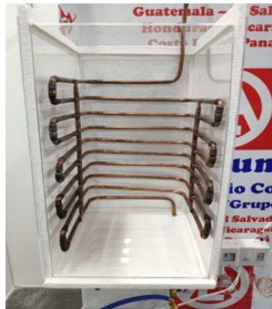
Figura 48: Ensamble del evaporador con el espacio refrigerado
