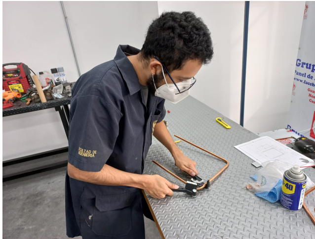
Figura 44: Dobléz de 90° en tubería de cobre flexible.
