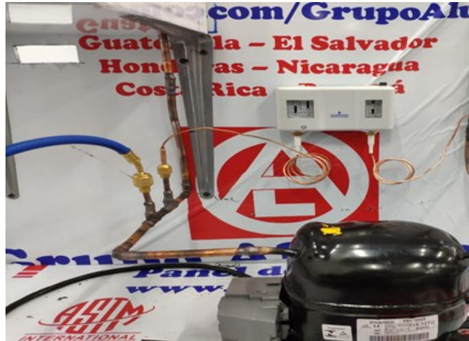
Figura 50: Tubería de succión del compresor
