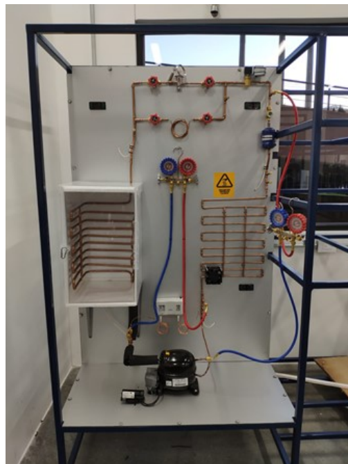
Figura 68: Ensamble completo del sistema de refrigeración
