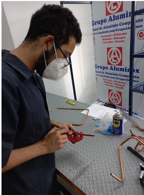
Figura 43: Proceso de corte de tubería de cobre flexible.
