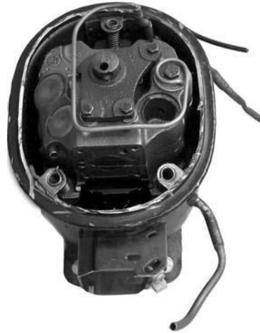
Figura 12. Vista superior de un compresor hermético [11].
