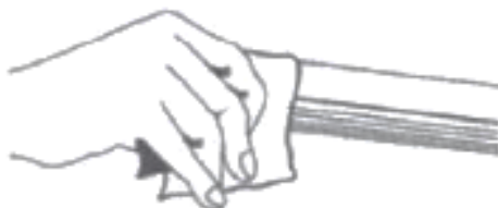
Figura 65. Limpieza superficial de tubería [14].
