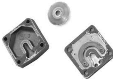
Figura 13. Tapa de cámara silenciadora, culata y placa de válvulas [11].
