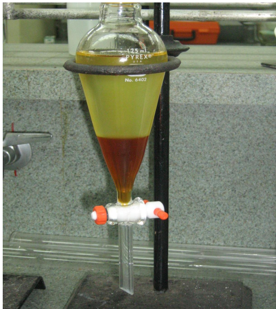
Imagen 2 Separación de fases biodiesel-glicerina
