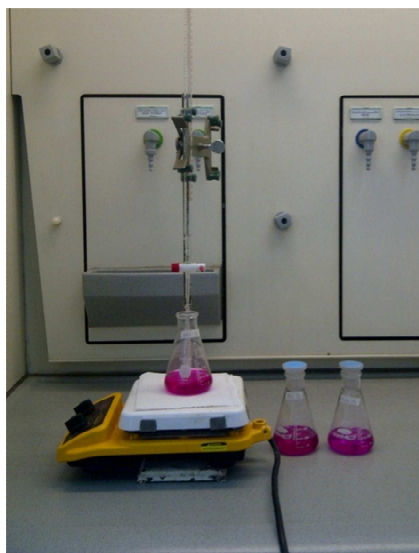
Fotografía No. 6: Sistema de titulación empleado para la determinación de datos experimentales
