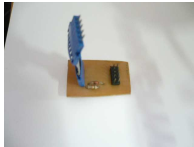
Figura 37: Adaptador para programación ICSP.
