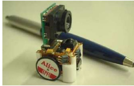
Figura 10: ALICE2002 con cámara CMOS de color [2] .
