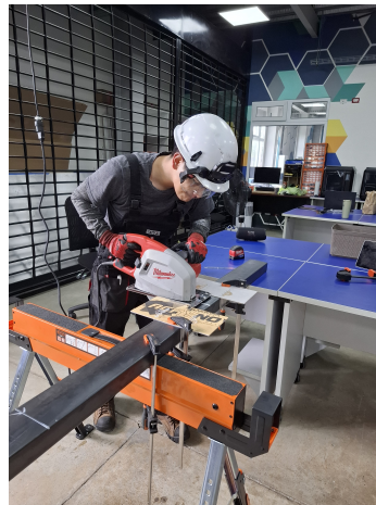
Figura 22. Proceso de corte en perfiles de acero
