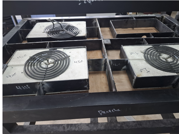
Figura 27. Bloques cerámicos con resistencias instaladas dentro del marco calefactor
