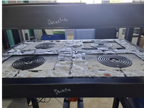
Figura 30. Vista final del marco calefactor inferior
