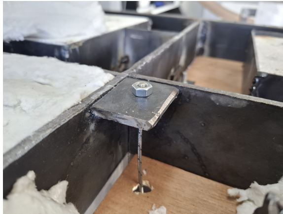
Figura 32. Termocupla instalada en el centro del marco calefactor
