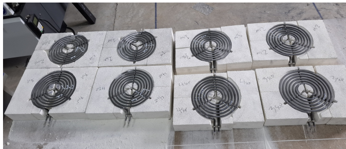
Figura 26. Ladrillos JM-23 maquinados, resistencias eléctricas instaladas
