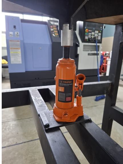
Figura 33. Integración del sistema hidráulico en la estructura
