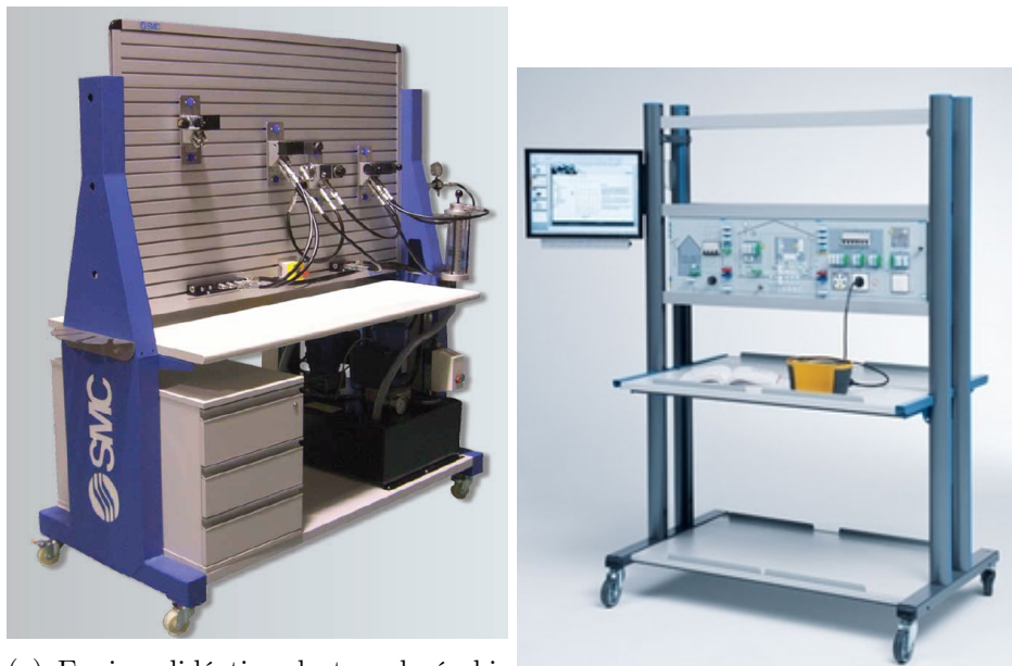
(a) Equipo didáctico de tecnología hidráulica Hidro Trainer de la compañía SMC [1] (b) Mesa de trabajo Swing para dos personas de la compañía FESTO [1]
