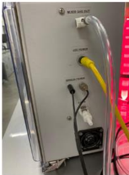
Figura 7. Sistema de conexión de cables y mangueras de la caja de control del reactor
